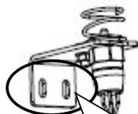
Ce support permet d'ajuster la position du contacteur sur trou oblong.
