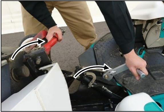
5) Utiliser la main droite pour relever le plateau déporté et tourner le levier de suspension vers la machine (côté intérieur).
