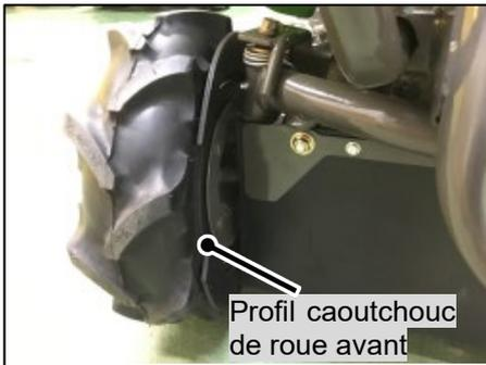
Vérifiez périodiquement que le profil de la roue avant ne contient pas d'herbe coupée ou de débris. Nettoyez si nécessaire.
