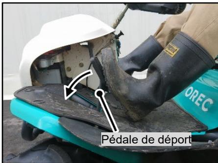
Actionner la pédale de déport permet de déployer ou rétracter manuellement le plateau déporté. Le plateau de déport se déploie lorsque le pied quitte la pédale.
