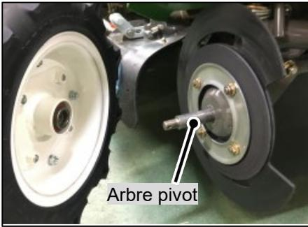
Nettoyer l'intérieur de la roue. Avant d'installer cette pièce, n'oubliez pas de graisser et de lubrifier l'arbre pivot.
